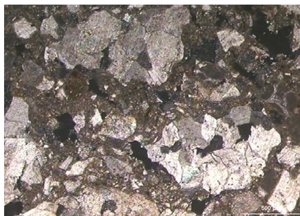
Fig. 23. Aggregato di “polvere di marmo” (m. ottica, sezione sottile, nicol+).
