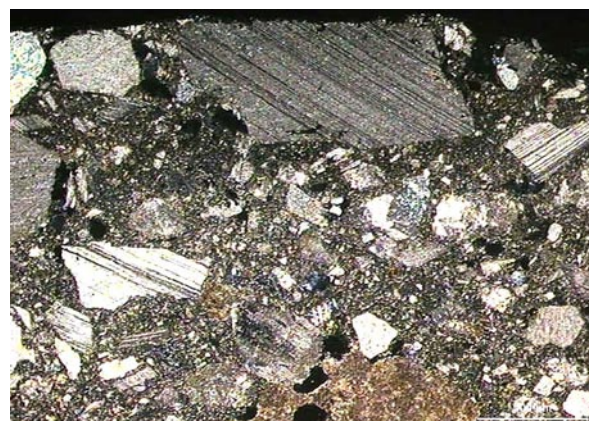
Fig. 25. Aggregato di calcite di venatura triturata (m. ottica, sezione sottile, nicol+).
