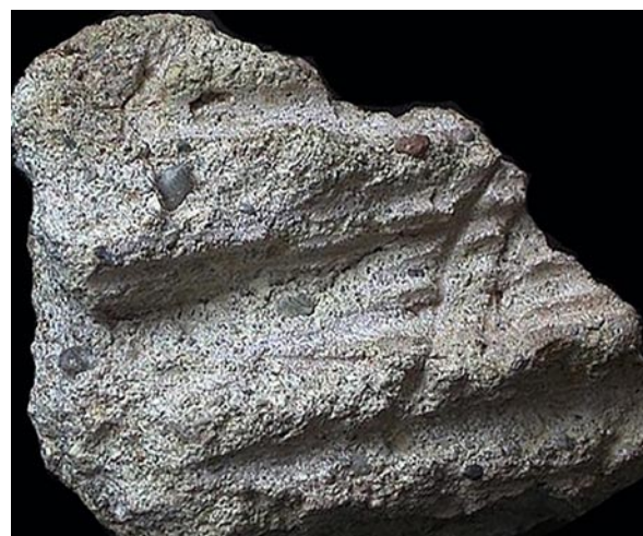
Fig. 28. Tracce di "incannicciata" sulla superficie inferiore di un intonaco (via C. Correnti).
