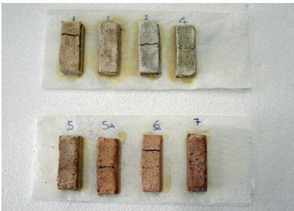
Fig. 72. Milano, via S. Valeria: prove per la scelta delle malte da utilizzare.
