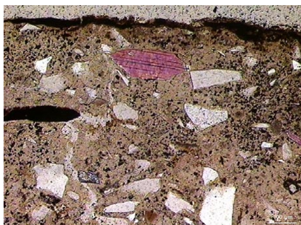
Fig. 31. Strato pittorico applicato con "latte di calce" (m. ottica, sezione sottile, nicol=).
